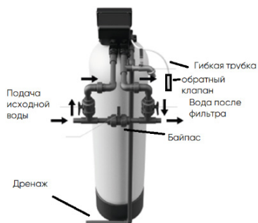
Подключение к водопроводу
