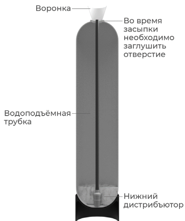
Заполнение фильтра материалом
