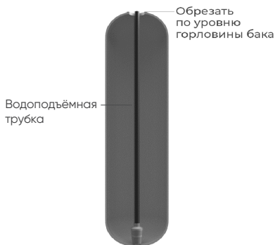
Обрезка водоподъемной трубы
